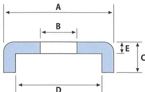
材質 ・ SUS304 ・ SPCC (熔融亜鉛メッキ)
